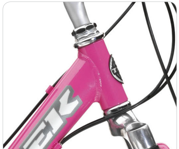
IMÁGEN 1 | Sin pletina de refuerzo; si el modelo aparece en el cuadro de la izquierda, es una bicicleta defectuosa.
